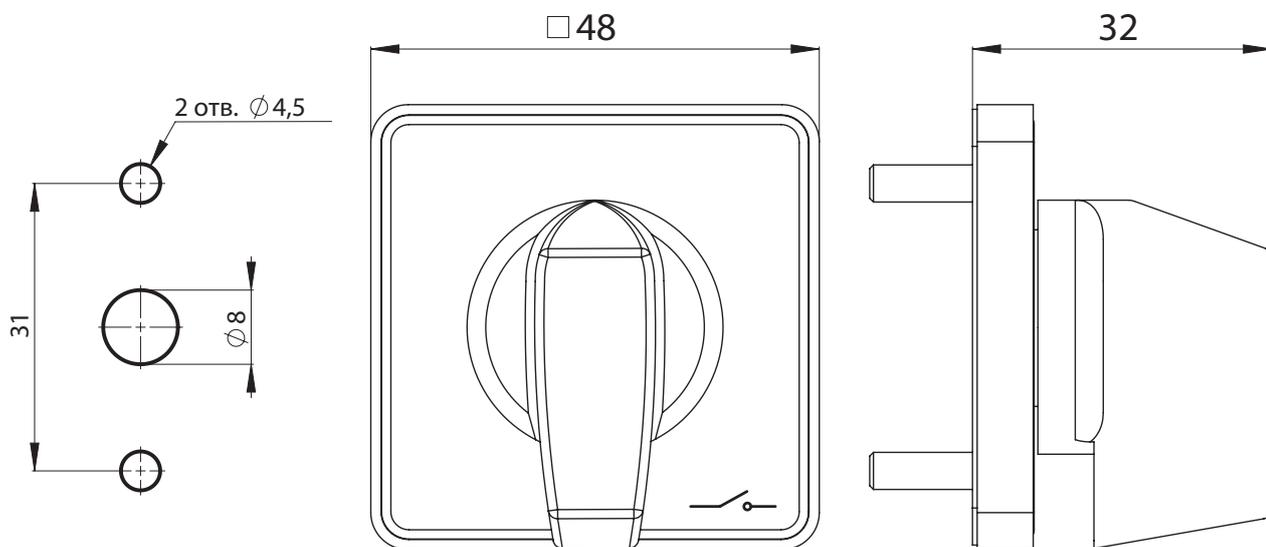
Расстояние между монтажными отверстиями 31 мм (2 винта M4x14)
