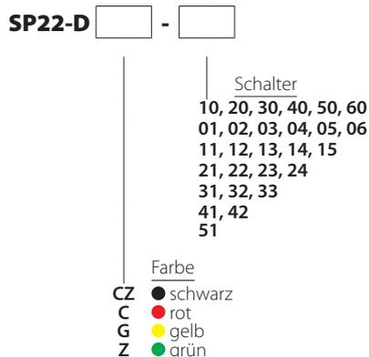
Bezeichnung der Schalter - die erste Zahl ist die Anzahl von Schließkontakten, die zweite Zahl ist die Anzahl von Öffnerkontakten.
